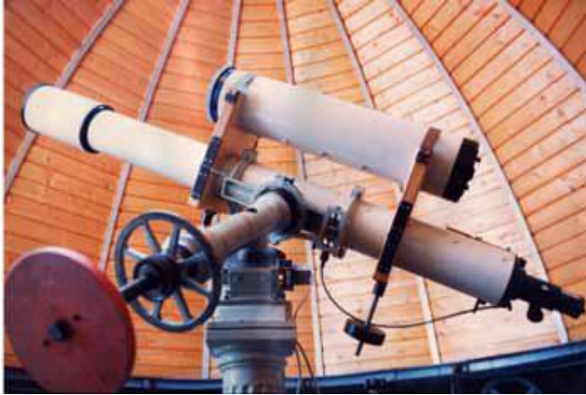
Das Hauptinstrument in der Beobachtungskuppel am Ägidienplatz: ein 15cm-Refraktor (Achromat)
